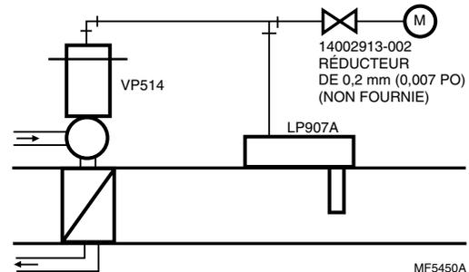
Fig. 7. Fonctionnement type d'un LP907A monté en gaine.
