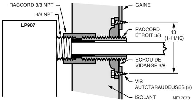
Fig. 3. Installation sur une gaine isolée.
