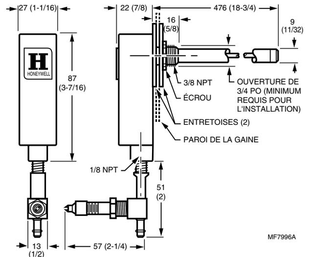
Fig. 1. Encombrement en mm (po) du LP907A.
