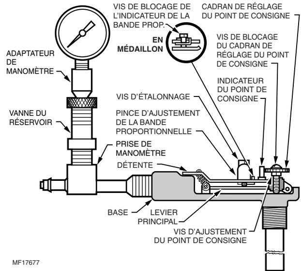
**Fig. 8. Ajustement du LP907A.**
