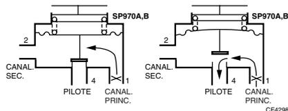
Fig. 6. Fonctionnement de SP970A/B.
