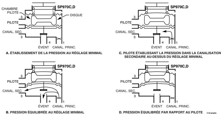
Fig. 7. Fonctionnement des SP970C et D.
